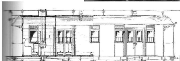
Abbildung 11: Gepäckwagen Bauart Langenschwalbach
